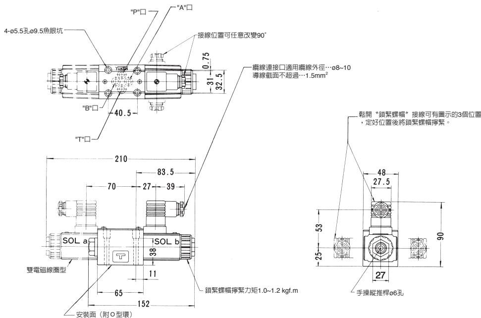
帶直流電磁鐵：※-DSG-01-※※※-D※-N/N1
